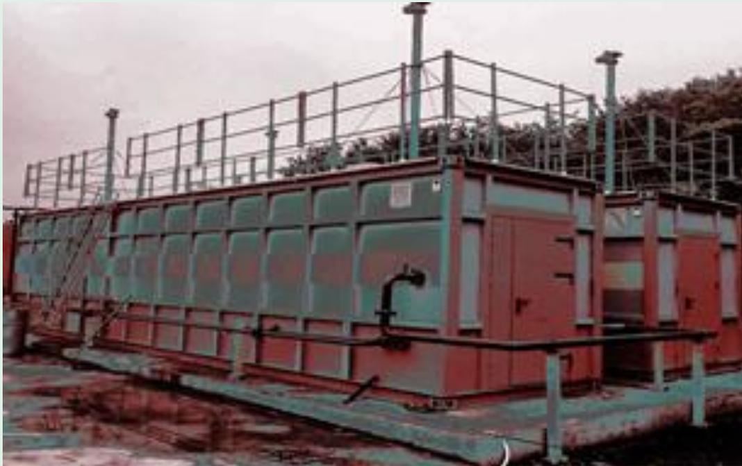
Мобильный комплекс, для производства взрывчатых веществ на объекте, это:
